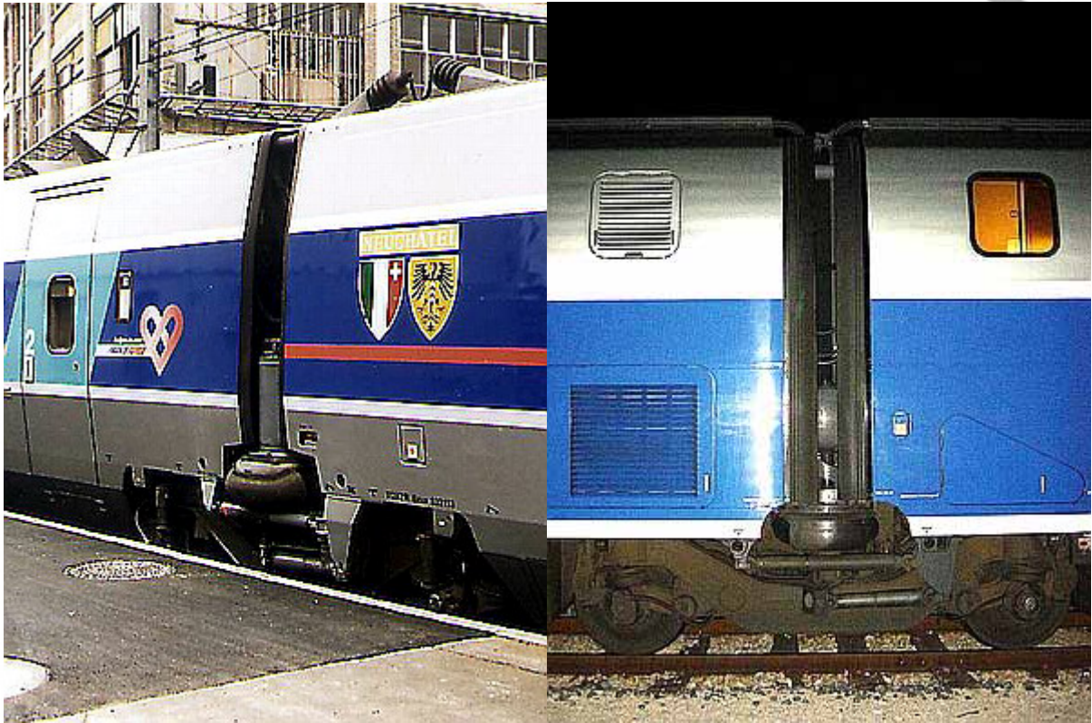
Abbildung 5-1: Jacobs-Drehgestelle bei TGV (links) und TGV-Duplex (rechts): Jeder Wagenkasten ruht jeweils zur Hälfte auf einem Drehgestell
