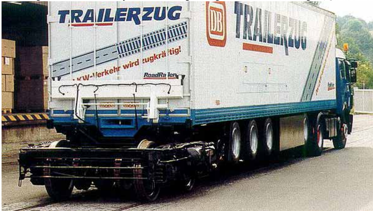
Abbildung 5-5: Güterverkehrssystem Trailerzug; Drehgestell und Sattelaufleger (Quelle: [45])
