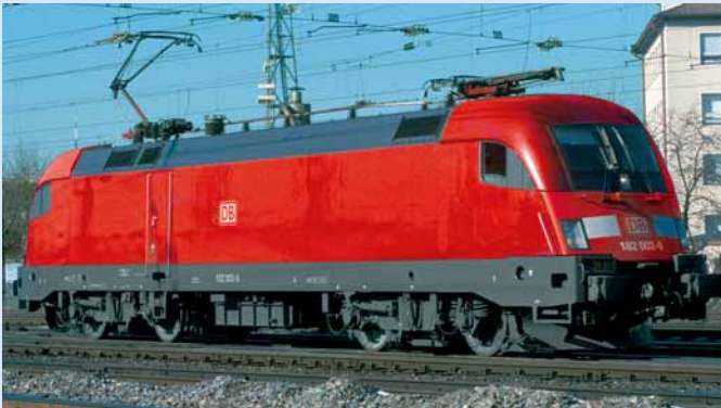
Lärmvermeidung konstruktiv von vornherein berücksichtigt: BR 182. Railion beschaffte diese Baureihe, um die österreichischen Zulassungsbestimmungen zu erfüllen, die auch Lärmgrenzwerte vorsehen. Dieser Typ wird inzwischen von zahlreichen in- und ausländischen Bahnen eingesetzt.
