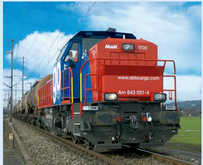
Die Baureihe Am 843 der Schweizerischen Bundesbahnen (SBB), erste serienmäßig mit Partikelfilter ausgerüstete Lokbaureihe. Die Möglichkeit, diese Loks auf Tunnelstrecken und -baustellen sowie in Werkshallen von Anschließern einzusetzen, bietet den SBB Rationalisierungsvorteile, die die Zusatzkosten für den Partikelfilter überwiegen.
