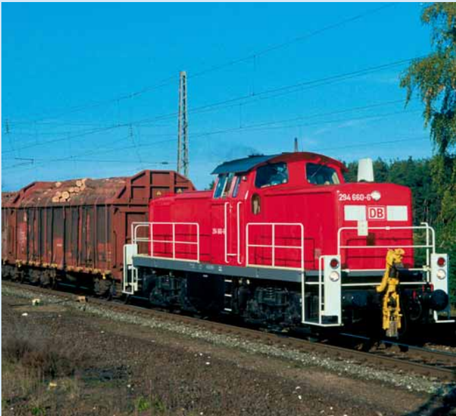
Raillon-Diesellok der BR 294 (Leistung 1.000 kW). Durch die Remotorisierung wurden Partikel und Stickoxid-Emissionen deutlich gesenkt.
