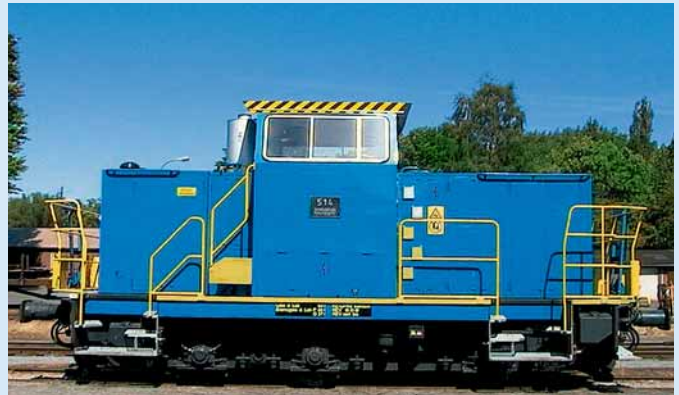
Modernisierte Diesellok der Verkehrsbetriebe Peine-Salzgitter. Durch systematisches Herangehen wurden Lärm- und Schadstoffemissionen sowie der Energieverbrauch verringert. Eine Leckageauffangwanne verhindert, dass das Erdreich kontaminiert wird.
