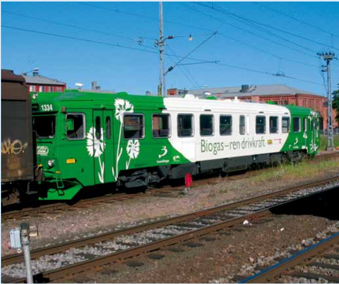
Am 21. Juni 2005 wurde in Schweden der erste Triebwagen mit Biogas-Antrieb vorgestellt – umgebaut aus einem Dieselloktriebwagen des Baujahres 1981. Ab September 2005 soll er im Fahrgasteinsatz zwischen Linköping und Västervik erprobt werden.
