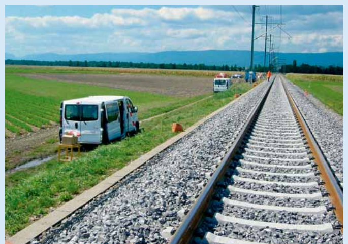
Lärmmessung an einer Schweizer Bahnstrecke
