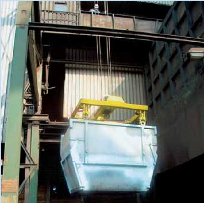
Bimodale Absetzmulde mit Nachschub für den Hochofen
